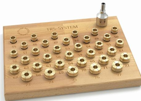
ist. Im Vorderteil des TRS-Dorns befindet sich eine konische Bohrung mit einem Anzugsgewinde, in der eine gleichfalls konisch nachbearbeitete Innensechskantschraube eingebaut ist. Durch den Anzug der Innensechskantschraube wird das geschlitzte Vorderteil des Dorns gedehnt und die daraus resultierende Durchmesseränderung an die wechselbaren Ringweitaufsätze gleichmäßig verteilt weitergegeben. Hierbei wird das aufgespannte Werkstück mit hoher Kraft gespannt und sowohl radial als auch axial
