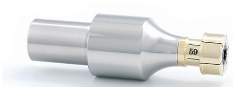
Das Spannsystem kann zur spannenden Bearbeitung der Außenkontur von rotationssymmetrischen Werkstücken auf konventionellen, sowie CNC-Dreh- und Fräsmaschinen eingesetzt werden. Basis des TRS-SYSTEMS ist der TRS-Dorn, der aus nichtrostendem Spezialstahl hergestellt
